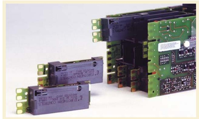
Das Modell 2704 verfügt über einen selbstkorrigierenden Eingangskreis (INSTANT ACCURACY), der die Kalibriergenauigkeit des Gerätes aufrecht erhält. Dadurch wird die Genauigkeit und das Betriebsverhalten während eines Starts und bei Temperaturänderungen der Umgebung stabilisiert.
