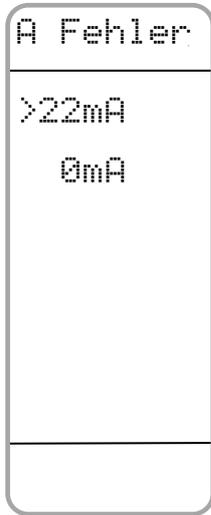
Abb. 24: Analogausgang Fehlerverhalten
