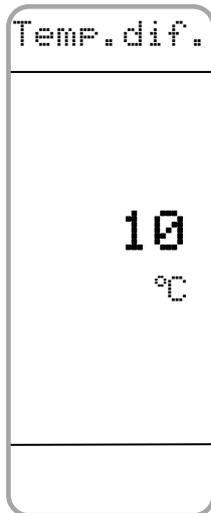
Mit dem Parameter Temperaturdifferenz kann der maximale Unterschied zwischen den beiden Thermoelementen eingestellt werden, der nicht zu einer Fehlerabschaltung führt.
