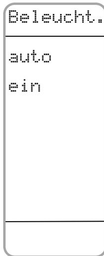
Auto: Die Display-Beleuchtung wird nach 2 Min. automatisch deaktiviert, wenn das Gerät nicht bedient wird.
