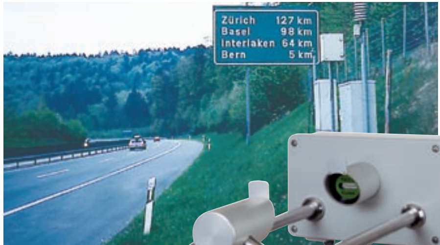
Laser-Niederschlagsmonitor zur Messung und Detektierung verschiedener Niederschlagsarten wie Niesel, Regen, Hagel, Schnee.
