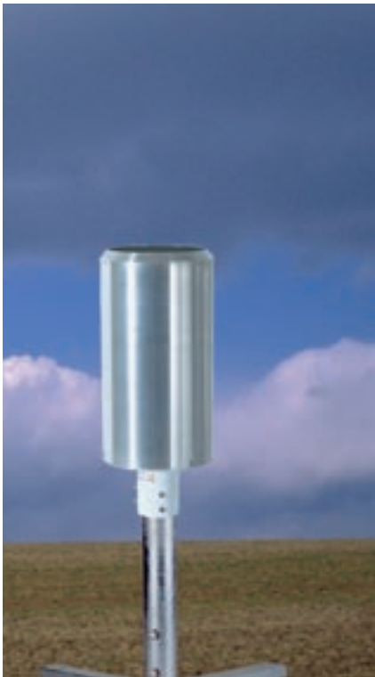
Niederschlagsgeber mit elektrischem Ausgang zur automatischen Datenerfassung
