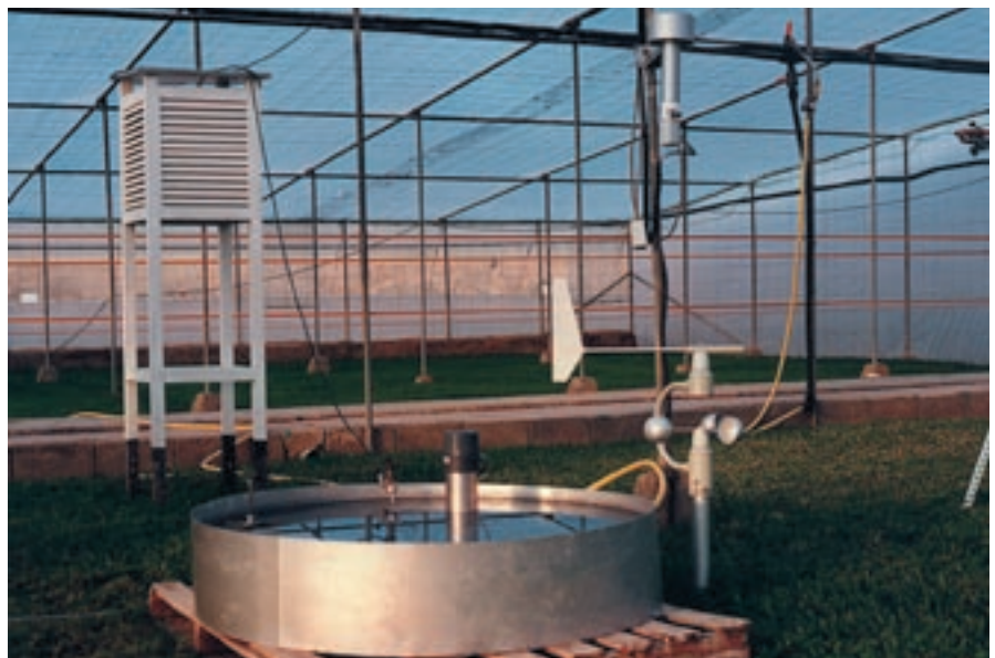
Niederschlagsmesser zur mechanischen Erfassung des Nieder- schlages für die Ermittlung des Wasserein- trages z.B. in Böden, Stauseen, Teichen etc.
